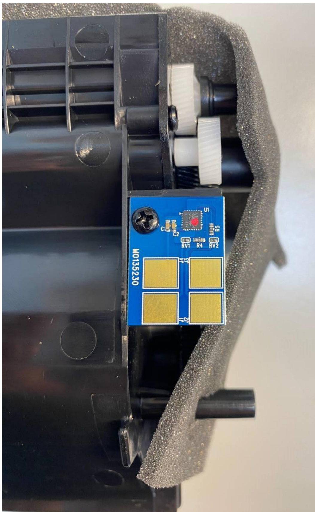
Рисунок 16. Чип тонер-картриджа. Нижняя часть блока, левая сторона.
