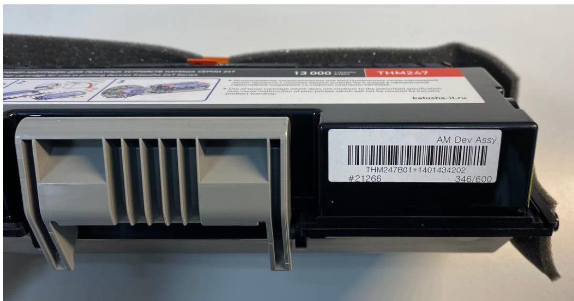
Рисунок 14. Серийный номер. Тыльная сторона блока. Ручка для транспортировки и замены блока. Наклейка с серийным номером и штрих-кодом.
